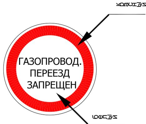
Рисунок Р.1 - Знак «Газопровод. Переезд запрещен»
