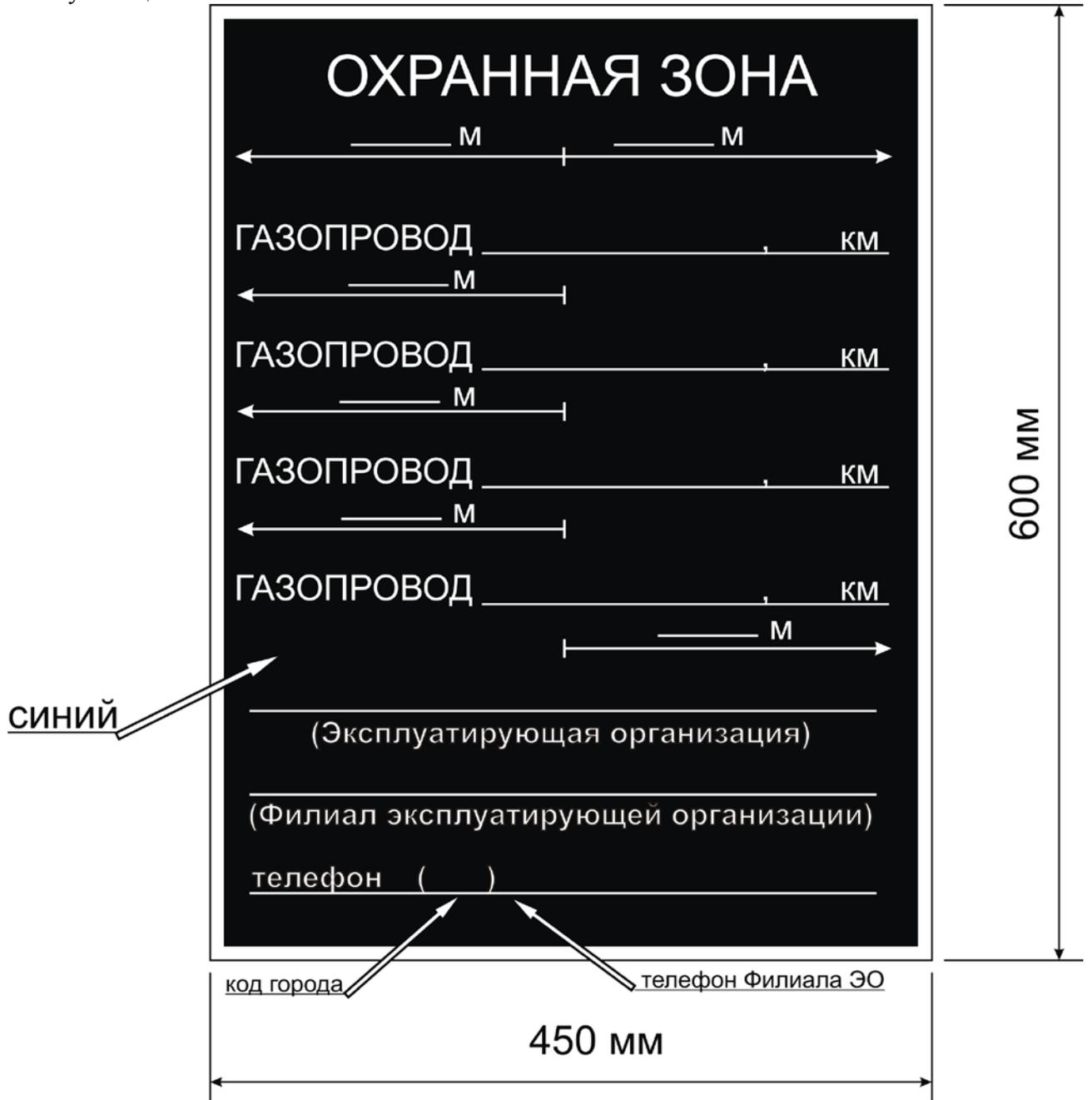
Рисунок Л.1 – Знак «Закрепление трассы газопровода на местности»
