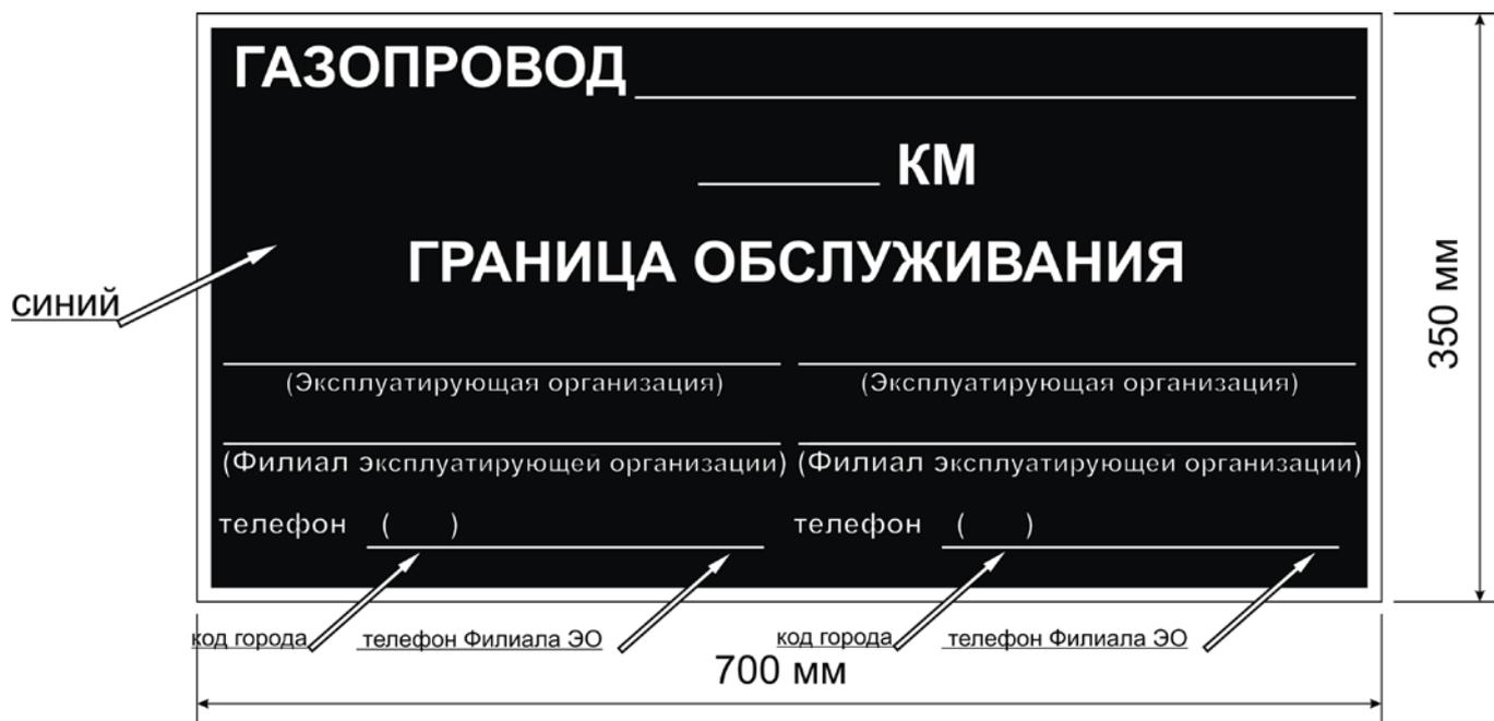
Рисунок П.1 - Знак «Закрепления границ зон обслуживания»
